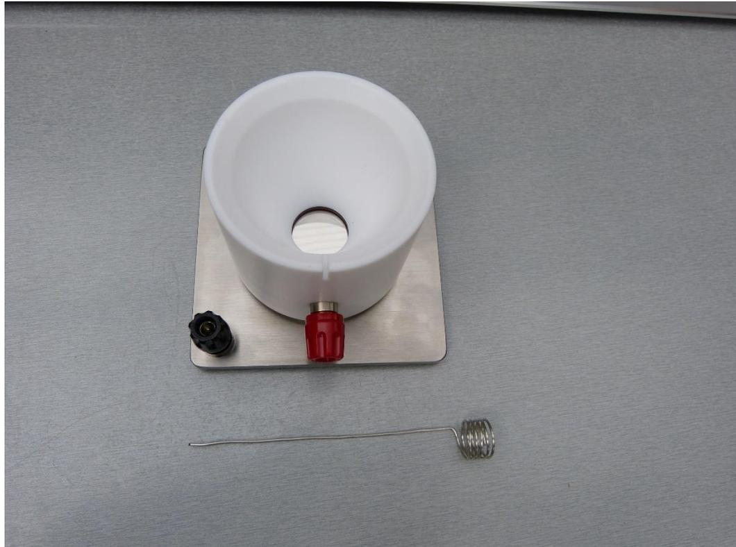
Tracerlab Electrodeposition-Cell „S-L“ - version CSC
