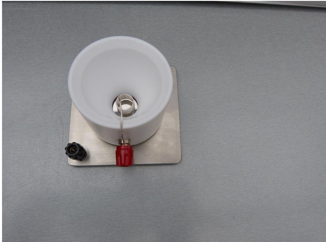
Tracerlab Electrodeposition-Cell „S-L“ - version CSC
